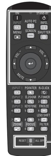
Nur diese Tasten sind aktiv wenn der vereinfachte Modus eingeschaltet ist (**Ein**). [ON, STAND-BY, INPUT, AUTO PC, INFO., MENU, SCREEN, SHUTTER, ▲▼◀▶, SELECT, VOL.+, VOL.-, MUTE, RESET/ON/ALL-OFF switch]-Zahlentasten (Seite 14) werden ebenfalls nur bei der Einstellung der Codes für die Fernbedienung oder der Eingabe der PIN-Codes aktiviert (Seiten 54, 60).
