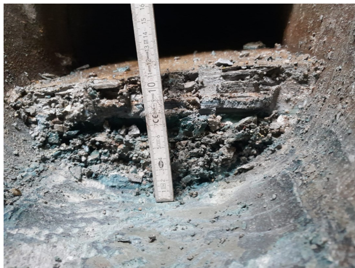
Die Ablagerungen sind bis zu 11 cm stark und verringern so den Durchmesser wesentlich. Foto: Fa. Quabus
